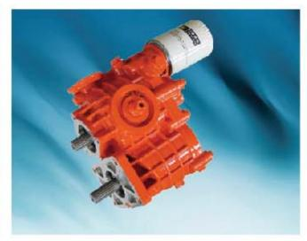
静液压传动装置,又称液压无极变速器(HST),集成液压泵、液压马达、控制阀、油滤 为一体,组成闭式系统,通过调节液压泵的排量,实现无级变速传动。
